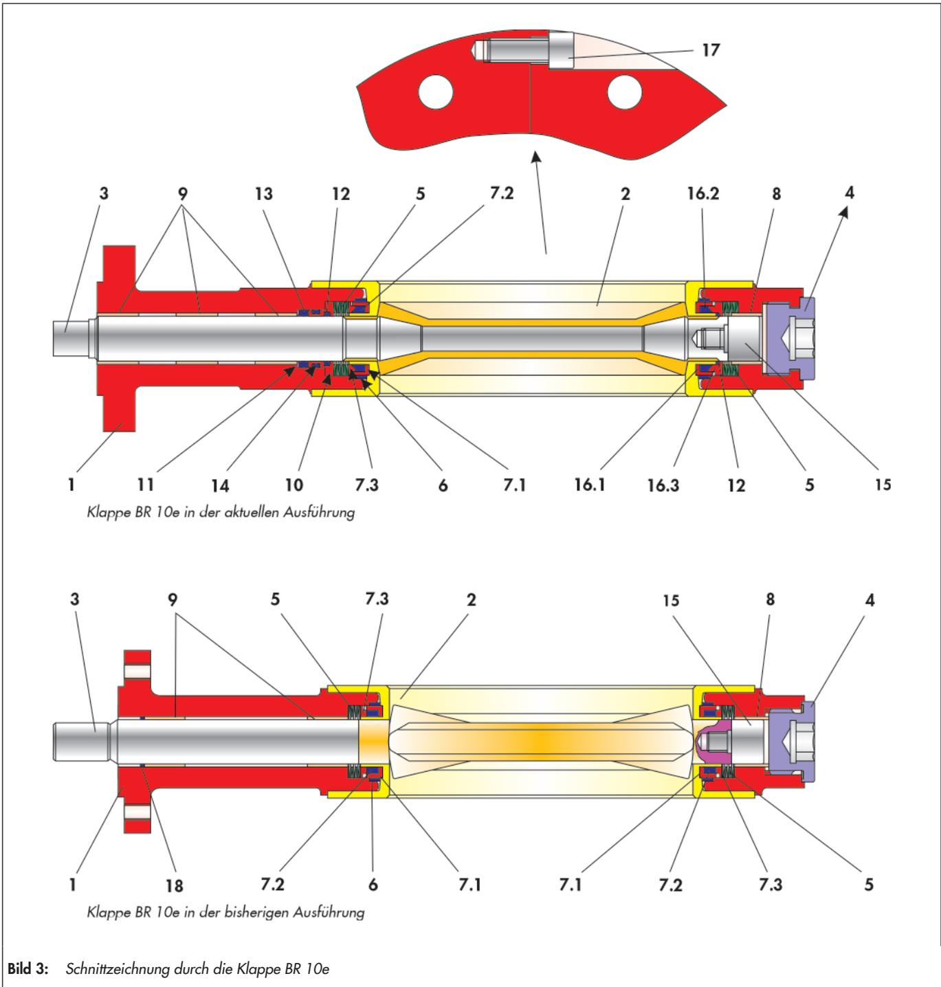
Bild 3: Schnittzeichnung durch die Klappe BR 10e
