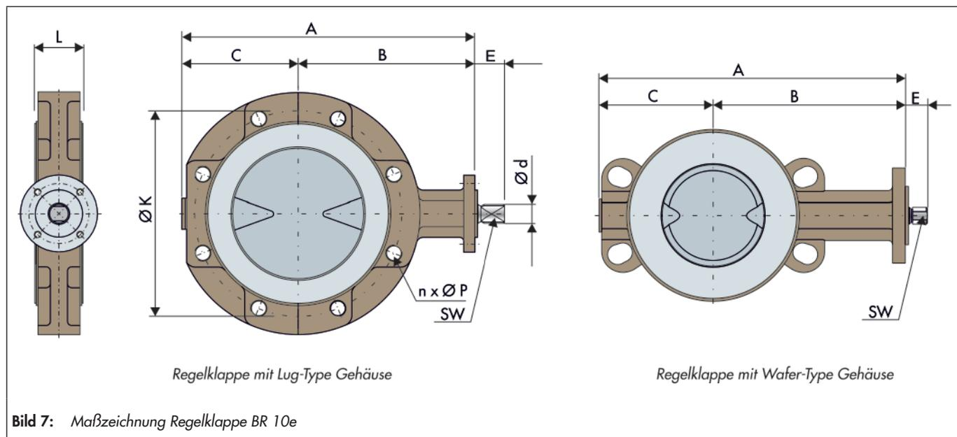
Bild 7: Maßzeichnung Regelklappe BR 10e
