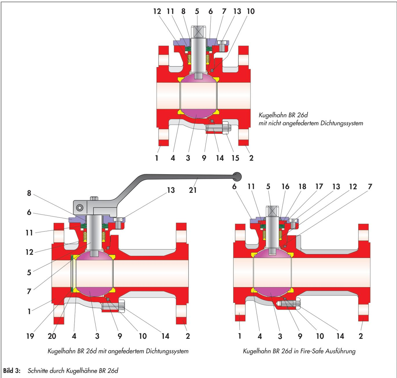
Bild 3: Schnitte durch Kugelhähne BR 26d
