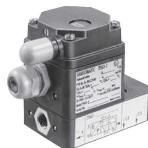
Fig. 1 : Électrovanne 5/2 voies · Monostable · Avec ressort de rappel · K_{VS} 0,16 · Raccord G ¼
