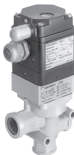
Fig. 2 : Électrovanne 3/2 voies · Monostable · Avec ressort de rappel · K_{VS} 4,3 · Raccord G ½
